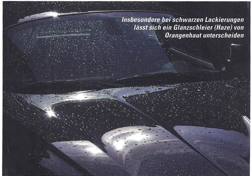
*Insbesondere bei schwarzen Lackierungen lässt sich ein Glanzschleier (Haze) von Orangenhaut unterscheiden*
